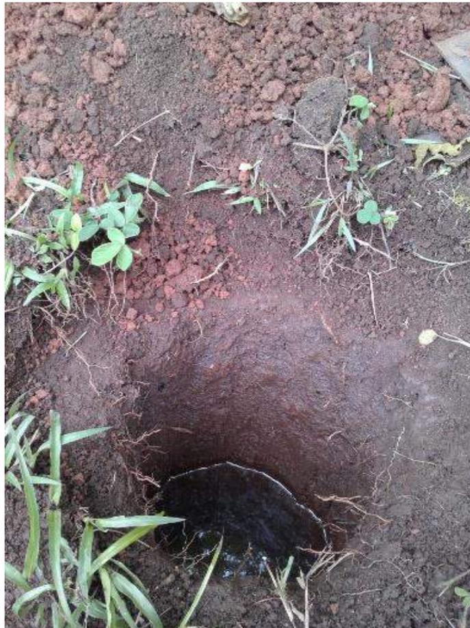
Foto 5. Prueba de infiltración PI-1, muestra el tipo de suelo obtenido de la excavación, se observan dos horizontes uno color negro a café oscuro y otro café-rojizo.
